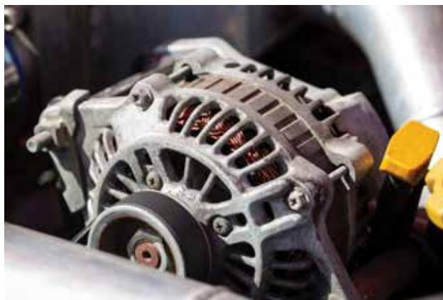
kod većine vozila napajaju radio, svetla, automatski prozori... Ako je alternator u kvaru vrlo brzo dolazi do pražnjenja akumulatora praktično tokom vožnje.
